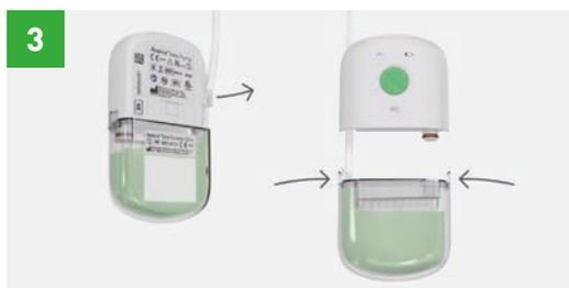
Libere el tubo en la parte trasera de la bomba. Presione con fuerza las lengüetas de plástico laterales y tire mientras se balancea suavemente para desconectar el contenedor. Conecte el nuevo contenedor. Debe esperar que el contenedor se ajuste firmemente, esto es necesario para mantener un sellado efectivo.
