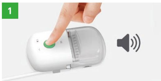
Detenga la bomba presionando el botón verde de arranque y suéltelo después de dos (2) segundos. La bomba emitirá dos pitidos para confirmar que está en modo de pausa.
